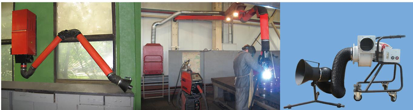
**V. Фильтровентиляционное оборудование для очистки воздуха при плавке драгоценных и цветных металлов, газотермическом нанесении покрытий, термообработке в расплавах солей, техпроцессах с образованием высокотоксичных аэрозолей цинка, свинца, олова, кадмия**
