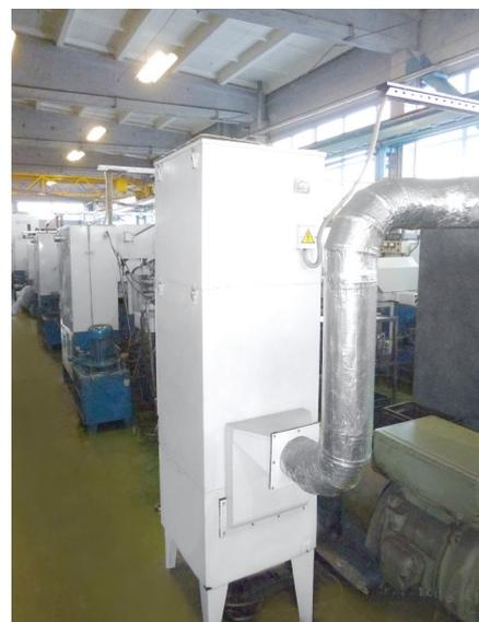
3) Фильтры ФВМ – для очистки воздуха от туманов масел и эмульсий. Самоочищающиеся, со сменными фильтрующими элементами. Стационарные.
