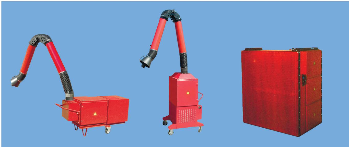
2) Фильтры ФСК-АП с автоматической продувкой фильтр-патронов – для очистки воздуха при сварке; плазменной, газовой и лазерной резке. С пультом управления, с программируемым контроллером, с измерительными приборами, с системой сигнализации. Тип фильтр-патронов и конструкция системы продувки выбираются в зависимости от техпроцесса. Передвижные и стационарные.
