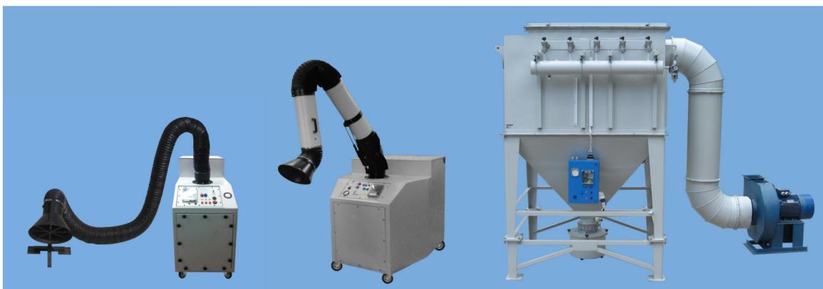
5) Фильтры рукавные ФРК-Э – самоочищающиеся, с импульсной продувкой, боковой установкой фильтро-элементов, малогабаритные. С пультом управления, программируемым контроллером, измерительными приборами, системой сигнализации. Имеют минимальные габариты по высоте. Фильтрующие ткани для рукавов выбираются в зависимости от техпроцесса. Стационарные.
