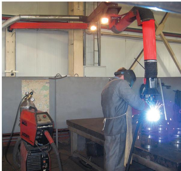
2) Местные отсосы – для удаления загрязненного воздуха от стационарных рабочих мест: мини-полноповоротные воздуховытяжные устройства МПВУ «Пластик» и МПВУ.
