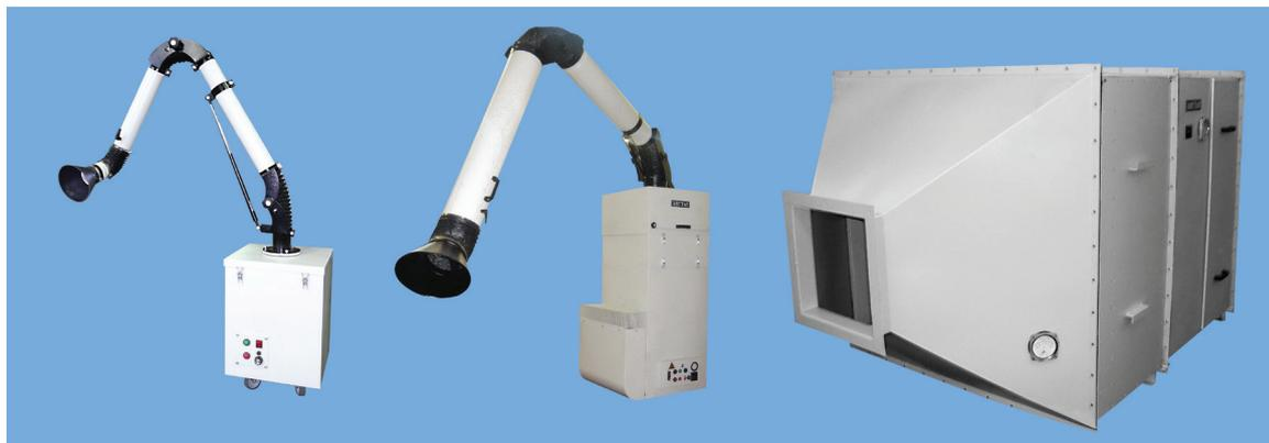
4) Фильтры ФСК-АП – самоочищающиеся, с автоматической продувкой фильтр-патронов. С пультом управления, программируемым контроллером, измерительными приборами, системой сигнализации. Тип фильтр-патронов и системы продувки выбираются в зависимости от техпроцесса. Передвижные и стационарные.
