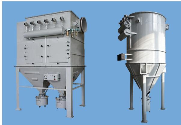
2) Фильтры рукавные ФРК-Э – самоочищающиеся, импульсной продувкой, боковой установкой фильтроэлементов, малогабаритные. С пультом управления, программируемым контроллером, измерительными приборами, системой сигнализации. Имеют минимальные габариты по высоте. Фильтрующие ткани для рукавов выбираются в зависимости от техпроцесса. Стационарные.
