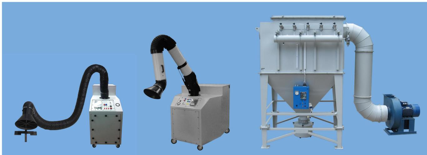
3) Фильтры ФСК накопительного типа, со сменными фильтрующими кассетами – для очистки воздуха при сварке (ремонтные, монтажные и регламентные работы), лазерной маркировке и гравировке. С пультом управления, с измерительными приборами, с системой сигнализации. Передвижные и стационарные.
